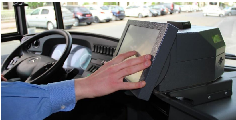
Abbildung 39: ITCS-Bordrechner am Fahrerarbeitsplatz in einem Linienbus (eigene Darstellung / Tobias Müller)
