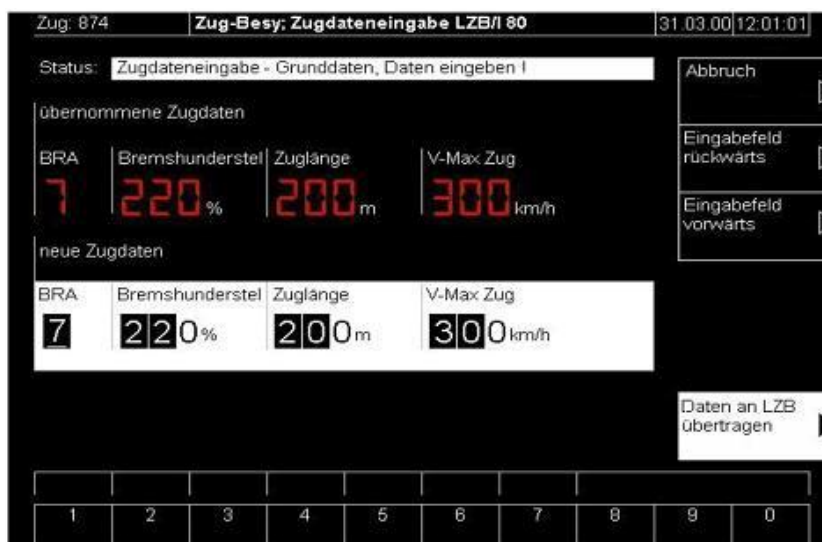
Abbildung 59: LZB-Zugdateneingabe per Display (Deutsche Bahn AG Ril 3248A02 [1])
