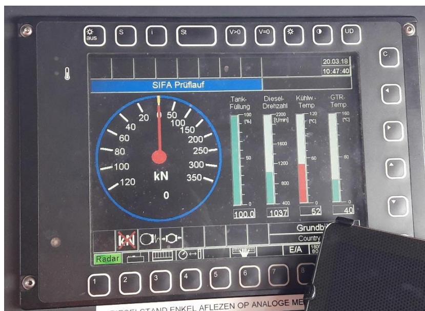
Abbildung 10: Technical & Diagnostic Display (TDD) am Beispiel des Tzf Vossloh G 2000 BB (eigene Darstellung)
