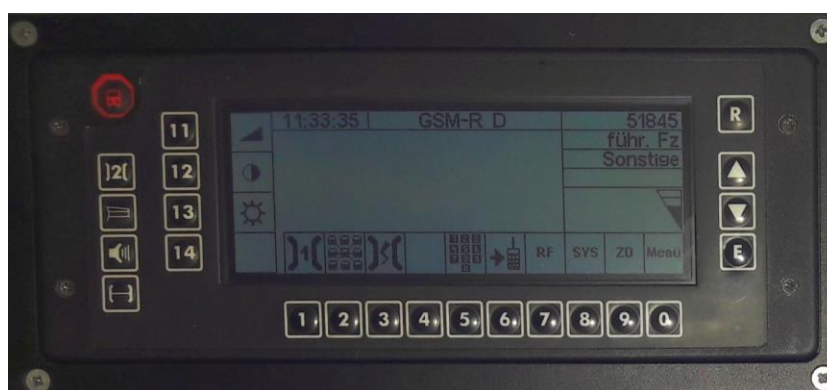
Abbildung 30: GSM-R Zugfunkgerät (eigene Darstellung)
