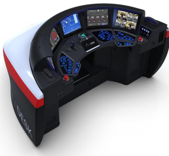
Abbildung 28: Fahrpultkonzept „IntelliDesk 2.0“ des Herstellers Schaltbau GmbH (Schaltbau GmbH [94])
