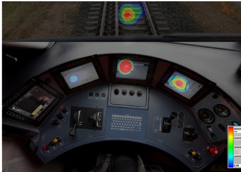
Abbildung 27: Blickbewegungsanalysen im EUIDplus während eines Beschleunigungsablaufes mit ETCS (TSB Innovationsagentur Berlin GmbH [91])
