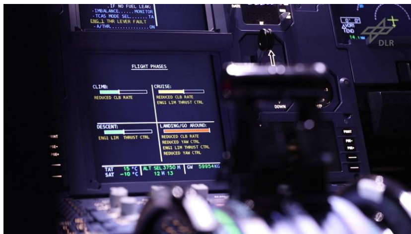
Abbildung 50: Display-Anwendung „Risk Information System“ im Cockpit (DLR 2016 [180])
