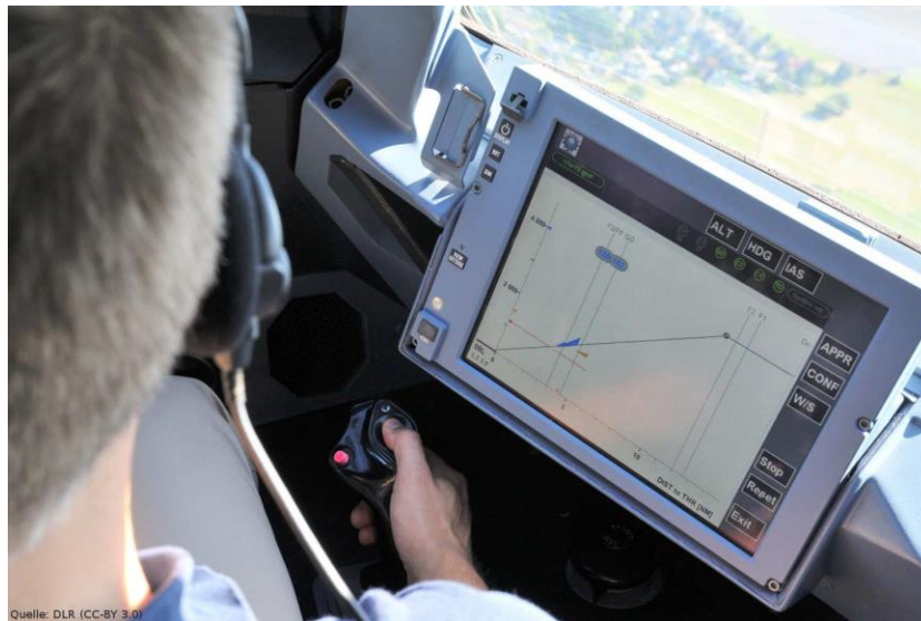
Abbildung 52: Display-Anwendung „Low Noise Augmentation System“ (LNAS) des DLR (Pressefoto DLR 2016 [180])
