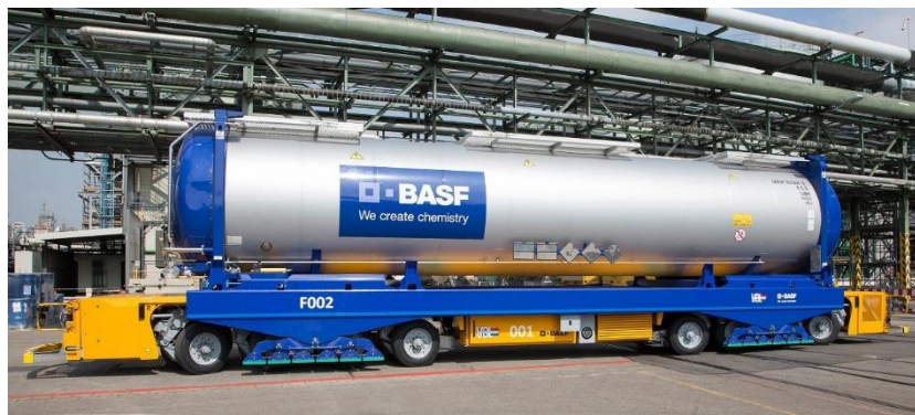
Abbildung 33: Automated Guided Vehicle auf dem BASF-Werksgelände (Pressefoto BASF SE)
