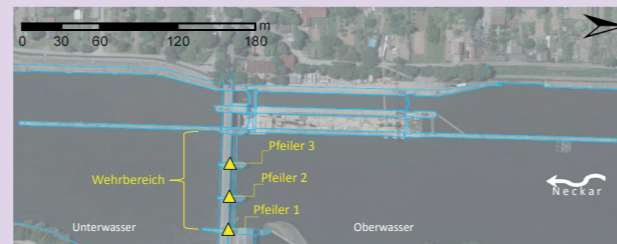
Abb. 1: Installationsorte der Neigungsmesssysteme im Wehr der Schleusenanlage Hessigheim (Quelle: Geo Basis-DE / BKG 2018)
