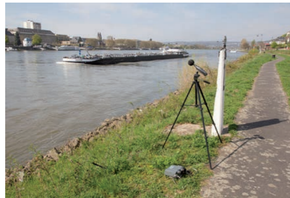
Abb. 1: Messung der Geräuschemission eines vorbeifahrenden Binnenschiffs.
