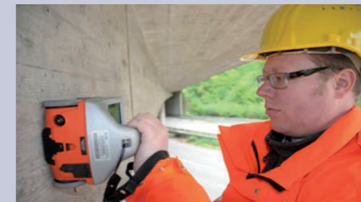
Abb. 3: Radarmessung an einer Brücke (Quelle: BASt 2018)
