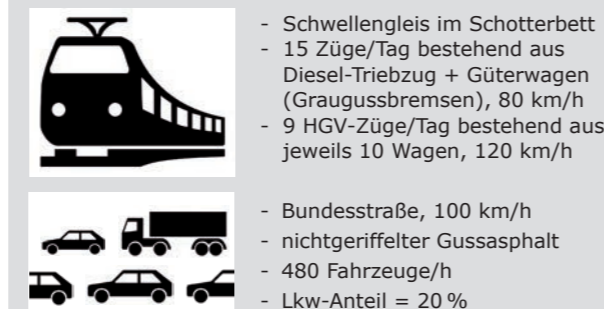
Abb. 3: Verwendete Quellmodelle von Straße und Schiene für den Methodenvergleich
