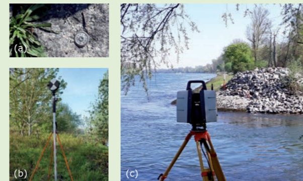
Abb. 1: (a) Festpunkt, (b) Reflektor und (c) terrestrische Erfassung einer Uferböschung mittels Laserscanner
