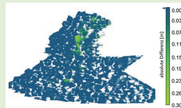
Abb. 2: Differenzmodell der Uferböschung
