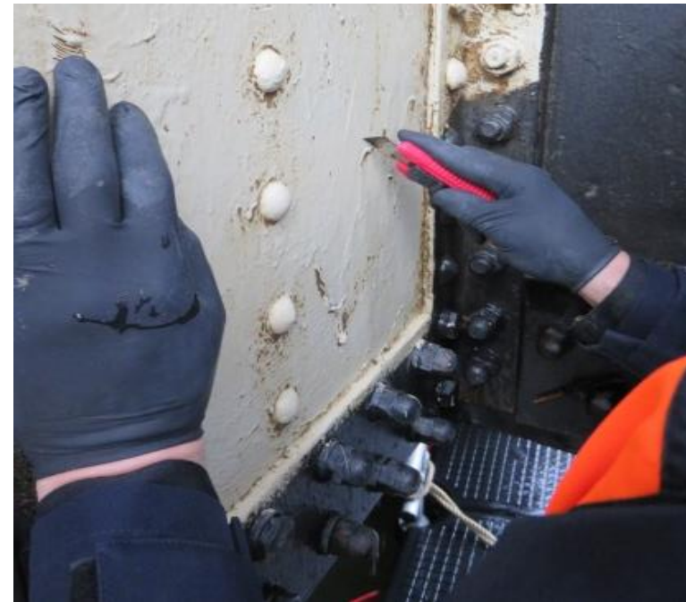
Haftfestigkeitsmessung durch Kreuzschnitt
