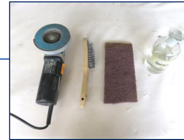
Verschiedene Oberflächenvorbereitungen Applikation mit Pinsel
