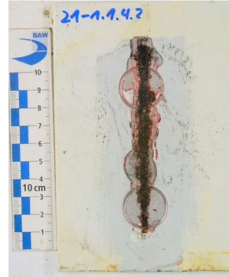
Messung des Grades der Korrosion
