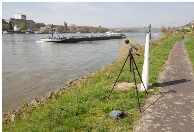
Abb. 1: Messung der Geräuschemission eines vorbeifahrenden Binnenschiffs.
