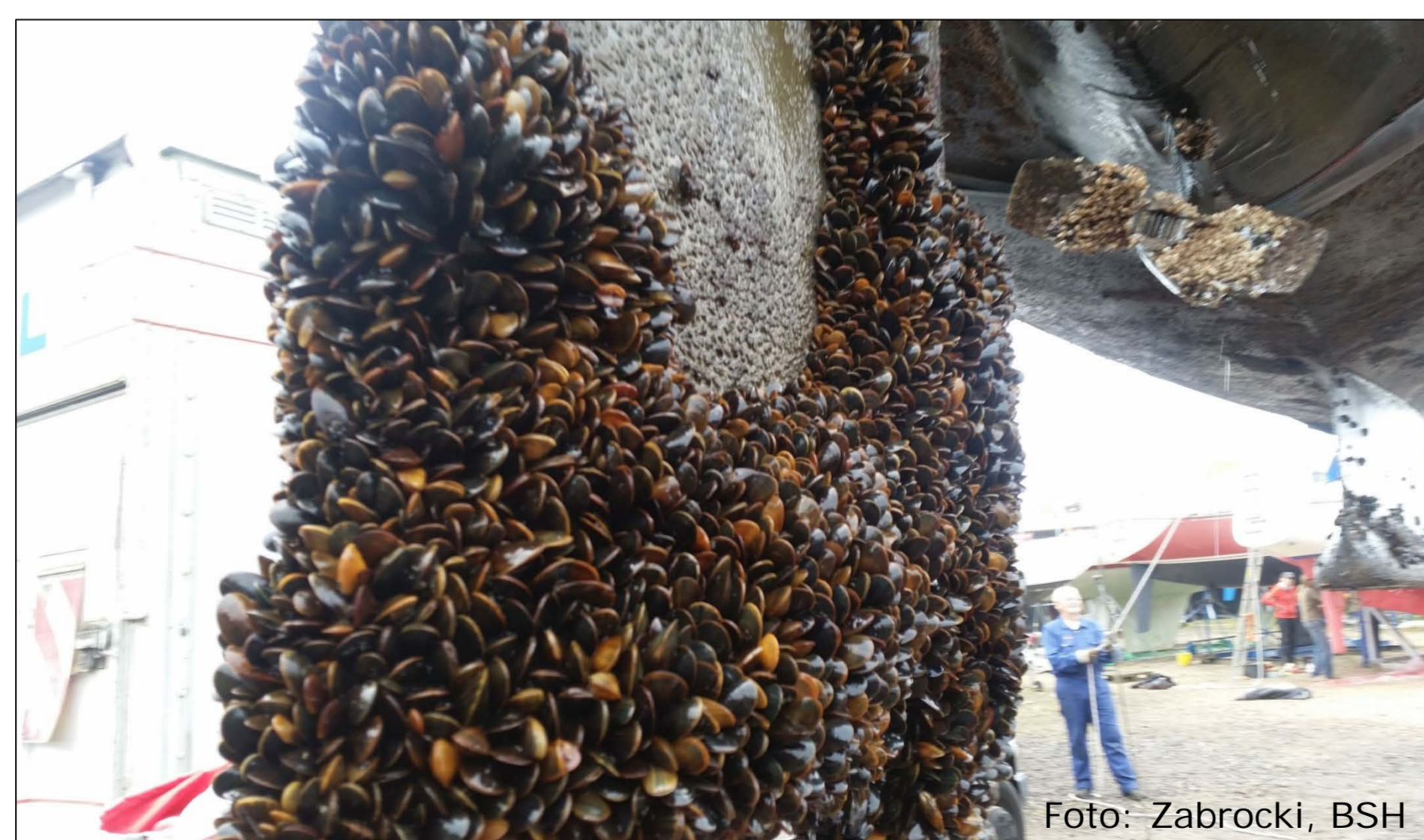
Abb. 3: Beispiel für einen sehr starken Bioaufwuchs an einem Segelboot. Das Boot wurde nur selten bewegt und wies hohe Liegezeiten auf. Die Arten werden zur Zeit im Labor bestimmt.
