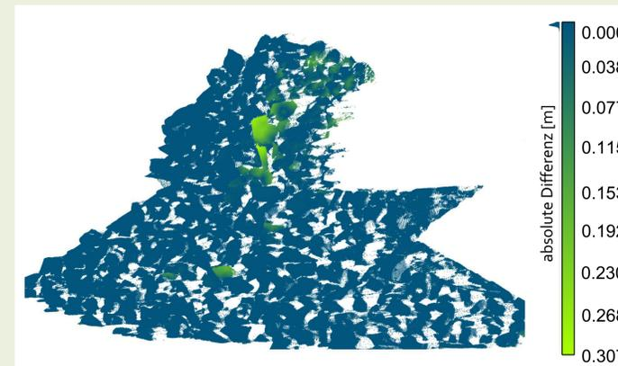
Abb. 2: Differenzmodell der Uferböschung
