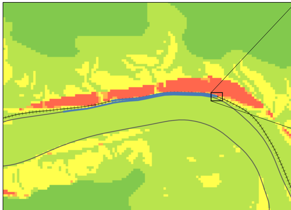
Hinweiskarte für gravitative Massenbewegungen mit Sicherungsbauwerken entlang der Infrastruktur
