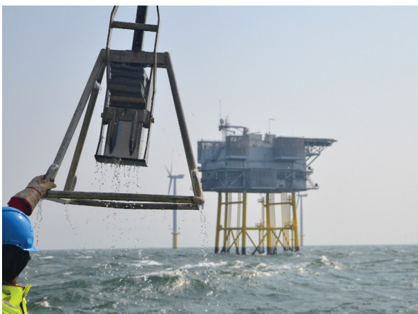
Abbildung 29 Probenahme auf See. Links: Kastengreifer für Sedimentprobenahme, rechts: Kranwasserschöpfer für Wasserproben (Foto: Torben Kirchgeorg, BSH).
