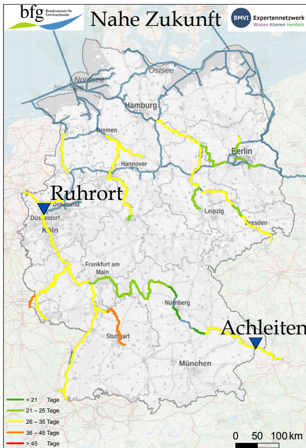
Abbildung 3-11: Mittlere Anzahl von Tagen mit Niedrigwasser unter dem Schwellenwert GIQ (bzw. Donau: RNQ) an den Binnenschiffahrtsstraßen in der nahen (links) und fernen Zukunft (rechts) basierend jeweils auf einer hohen Schätzung (85. Perzentil) für das Weiter-wie-bisher-Szenario . Kanalstrecken und Küstenwasserstraßen sind aufgrund geringer Sensitivität gegenüber Niedrigwasser ausgespart (blau).
