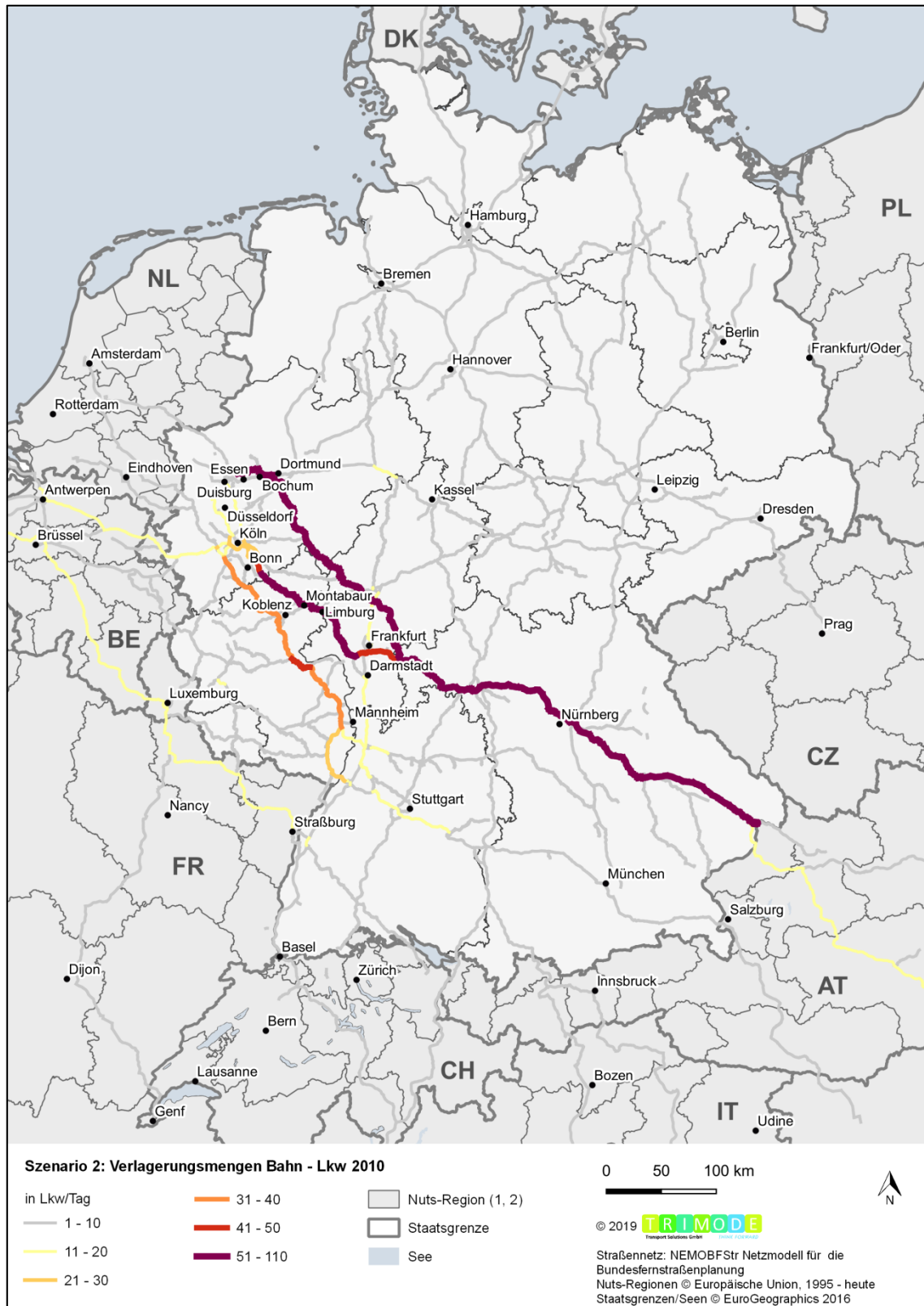
Abbildung 3-10: Routen der von der Schiene auf die Straße verlagerten Verkehre (Analyse 2010); Quelle: TTS TRIMODE Transport Solutions GmbH.
