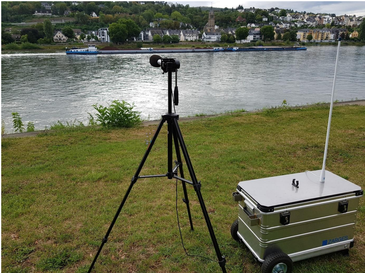
Abbildung 1: Testmessung von Schalldruckpegeln am Rhein bei Koblenz. Mittig im Bild: Mikrofon mit Stativ, rechts im Bild: Schallmessbox mit aufgestellter AIS-Antenne. Foto: S. Sommer, BfG.
