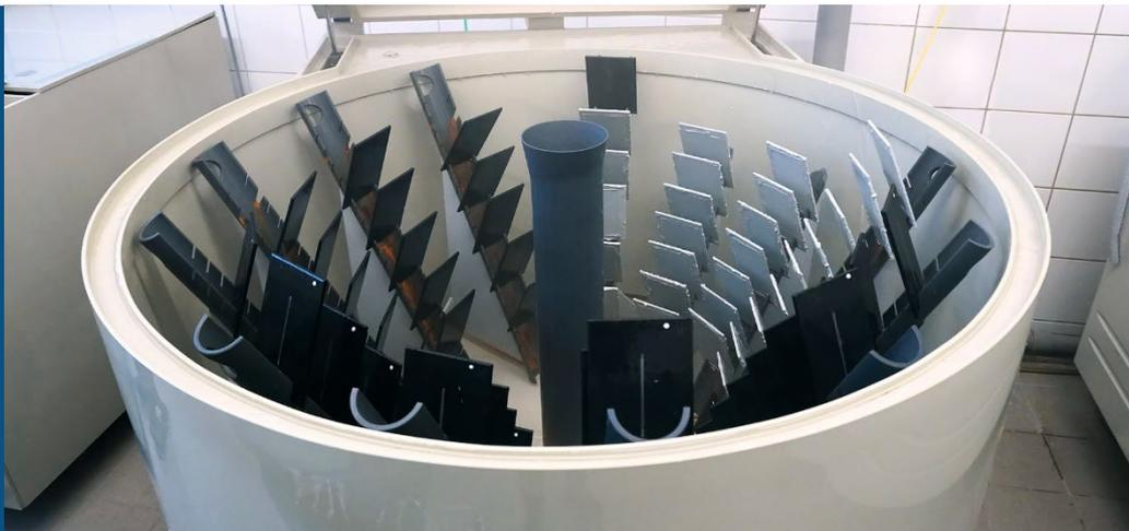
Abb.1: Probeplatten in der Prüfkammer vor Versuchsstart des Salzsprühnebeltests.
